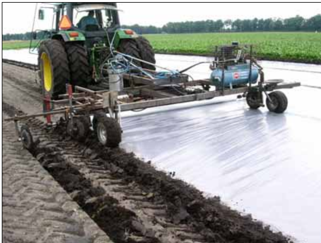
Foto 1 Folielegger lijmt foliebanen aan elkaar
